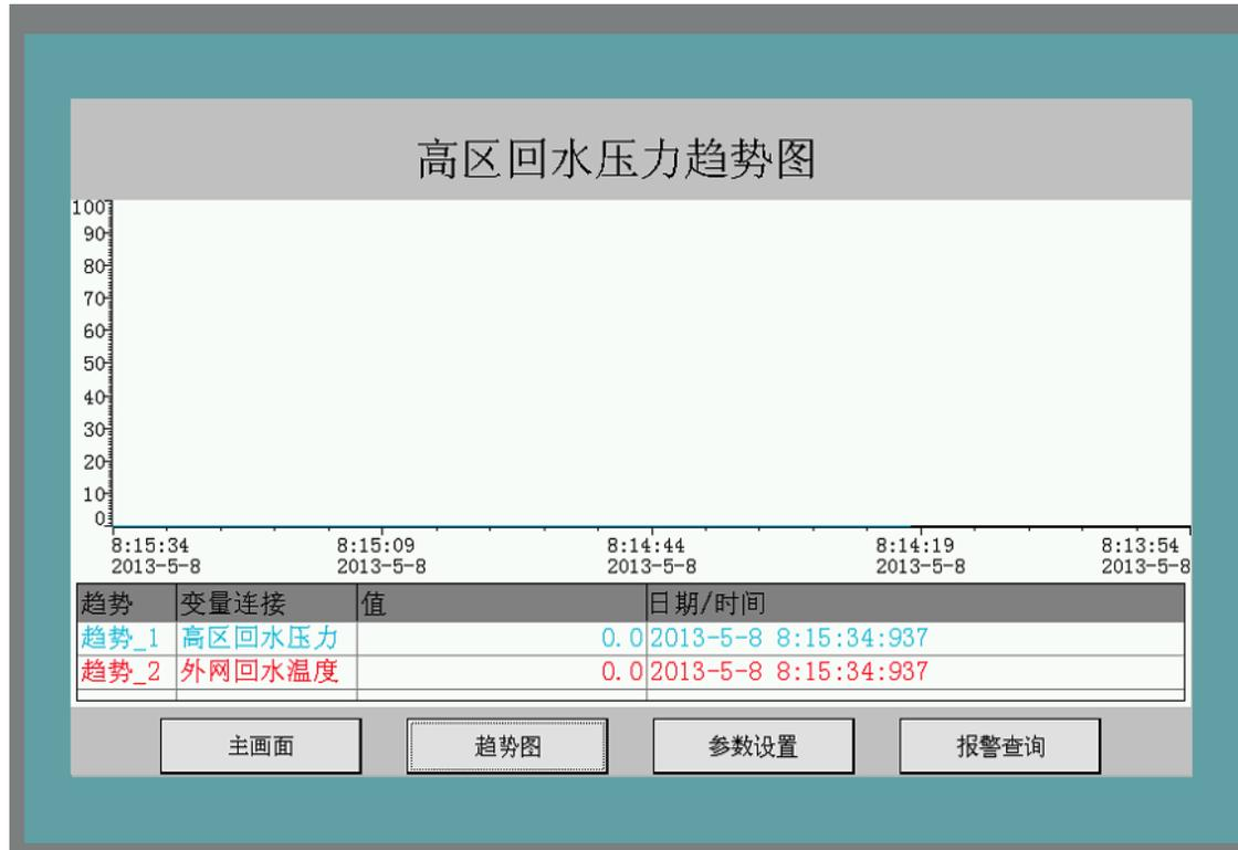
趋势图画面以图形的形式实时的显示高区回水压力和外网回水温度的变化情况
